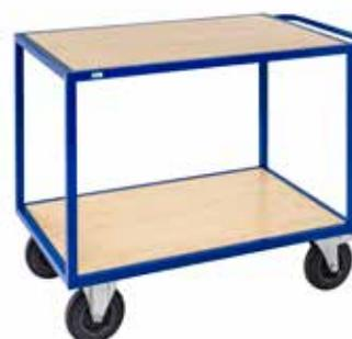
Pulverbeschichtet mit MDF Platte. Markierungsfreie Rollen. 2 Böden. Höhe bis zum ersten Boden: 240 mm. Abstand zwischen den Böden: 630 mm. Ladekapazität je Boden: 600 kg. Rollen: 2 Bockrollen 2 Lenkrollen mit Bremse. Rollendurchmesser: 200 mm.
