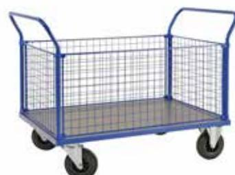
Pulverbeschichtet mit MDF Platte. Markierungsfreie Rollen. 1 Böden. Höhe zum Griff: 1060 mm. Rollen: 2 Bockrollen 2 Lenkrollen mit Bremse. Rollendurchmesser: 200 mm.
