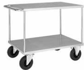
Galvanisch verzinkt. Rohre aus 25 mm Stahlrohr. Bodenplatte verzinkt. Höhe zum Griff: 900 mm. Rollen: 2 Bockrollen 2 Lenkrollen. Rollendurchmesser: 200 mm.
