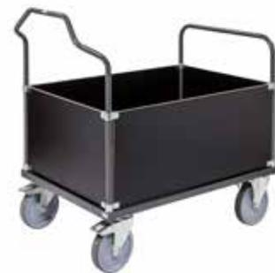
Pulverbeschichtet mit MDF Platte. Markierungsfreie Rollen. 2 Böden. Abstand zwischen den Böden: 580 mm. Ladekapazität je Boden: 250 kg. Höhe zum Griff: 1070 mm. Rollen: 2 Bockrollen 2 Lenkrollen mit Bremse. Rollendurchmesser: 200 mm.
