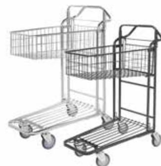
Automatische Bremse im Griff - lässt man den Griff los, bremst der Wagen. 2 Böden. Höhe bis zum ersten Boden: 200 mm. Abstand zwischen den Böden: 500 mm. Ladekapazität je Boden: 100 kg. Höhe zum Griff: 1030 mm. Rollen: 2 Bockrollen 2 Lenkrollen mit Bremse. Rollendurchmesser: 100 mm.
