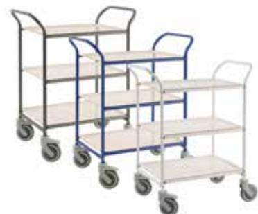
Pulverbeschichtet. 3 Böden. Abstand zwischen den Böden: 290 mm. Rollen: 4 Lenkrollen 2 davon mit Bremse. Rollendurchmesser: 125 mm.
