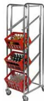
Pulverbeschichtet. Einstellbare Böden. Innenmaße: 420 x 540 x 1110 mm. 3 Böden. Ladekapazität je Boden: 50 kg. Rollen: 4 Lenkrollen 2 davon mit Bremse. Rollendurchmesser: 100 mm.
