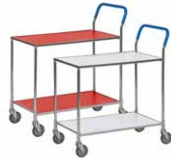
Galvanisch verzinkt mit laminiertes Platte. Komfortabler Kunststoffgriff. 2 Böden. Höhe bis zum ersten Boden: 180 mm. Abstand zwischen den Böden: 510 mm. Ladekapazität je Boden: 75 kg. Rollen: 4 Lenkrollen. Rollendurchmesser: 100 mm.
